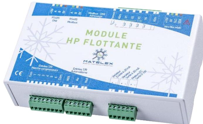
Complémentaire au DNI, le module HP Flottante permet de réguler en continu la consigne optimale de pression de condensation en fonction de la température extérieure. En effet, réguler la pression de condensation réduit les consommations énergétiques en améliorant le coefficient de performance de votre installation frigorifique.
